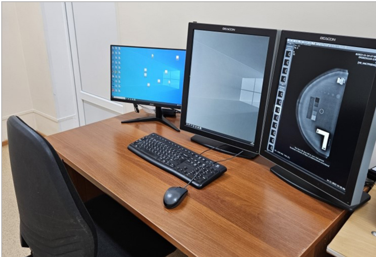
Рис. 5. Рабочая станция врача-рентгенолога со специализированными мониторами с разрешением 5 Мп
