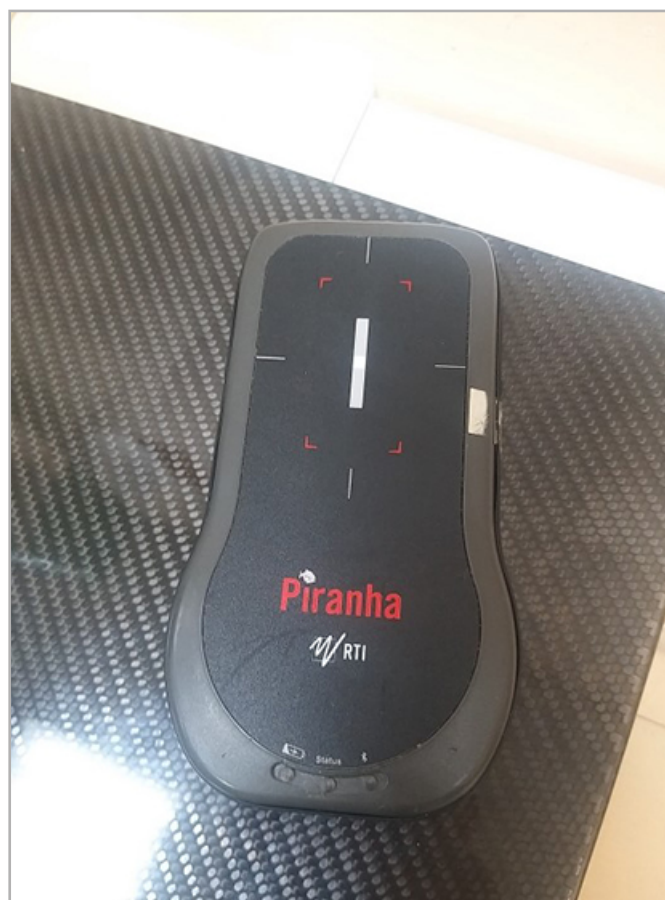
Рис. 4. Внешний вид универсального дозиметра Piranha, используемого для эксперимента (производитель RTI, Швеция)
